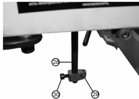
Установить винт точной регулировки с гайкой фиксирующей (27) в резьбовое отверстие блока (23) Рис.7. Установить на штифт копирующий (28) ролик копирующий (29) и зафиксировать его болтом с круглой головкой (30) Рис.8. Установить штифт копирующий (28) Рис.8 в паз траверсы (Рис.11 №25). Закрепить в нужной позиции с помощью шайбы и двух шестигранных гаек (Рис.11 № 60, 27).
