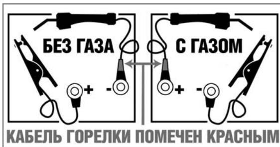
1. Используйте зажим заземления для соединения кабеля заземления и рабочей поверхности. Убедитесь, что зажим имеет хороший контакт с рабочей поверхностью, удалите ржавчину и краску с места контакта.
