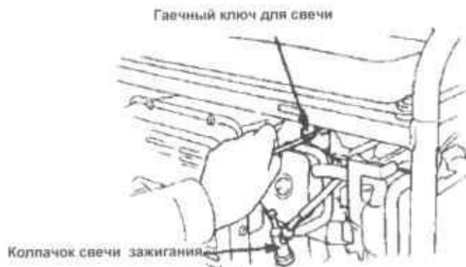
4. Осмотрите свечу зажигания. Выбросьте ее, если изолятор треснул или от него откололся кусок. Если свеча пригодна для повторного использования, прочистите ее проволочной щеткой.
