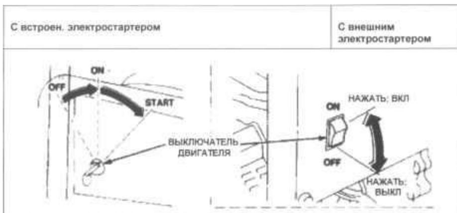
Верните ключ в положение ВКЛ (ON) сразу же после запуска двигателя. Не используйте стартер за раз более чем 5 секунд. Если двигатель не запускается, отпустите выключатель и подождите 10 секунд перед тем, как снова зажигать стартер.
