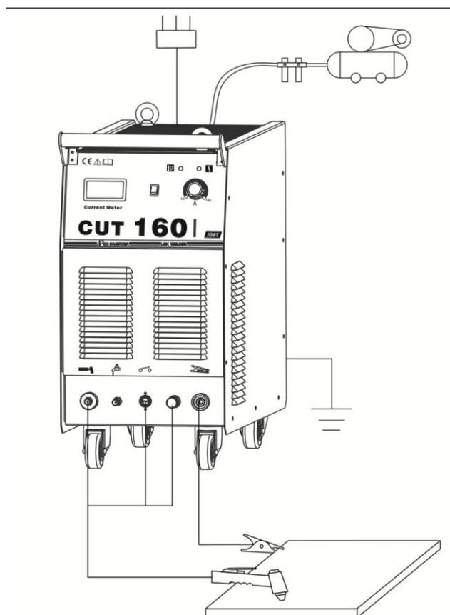
7. Подключите плазматрон, кабель заземления, компрессор (CUT встроенный компрессор) как показано на рисунке. Кабель управления плазматроном должен быть подсоединен к разъему на панели управления.
