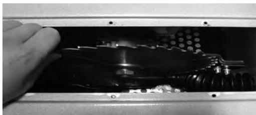
Открутите гайку крепления пильного диска и снимите внешний фланец.
