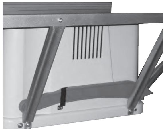
Для удобства хранения толкателя на корпусе станка размещается крепление для толкателя.
