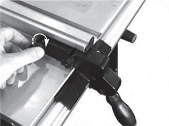
Передвижной блок размещается на передней части рабочего стола и легко перемещается по направляющей параллельного упора. Для фиксации его положения опустите ручку фиксации.
