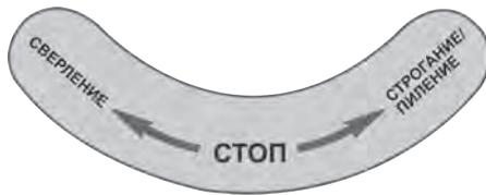
**ВНИМАНИЕ!** Переключиться с режима «Стругание/Пиление» на «Сверление» и наоборот можно только после полной остановки двигателя. Сначала переведите рычаг выключателя в положение «Стоп», дождитесь полной остановки двигателя, после этого переведите рычаг в другое положение. Несоблюдение этого требования может вызвать поломку станка.
