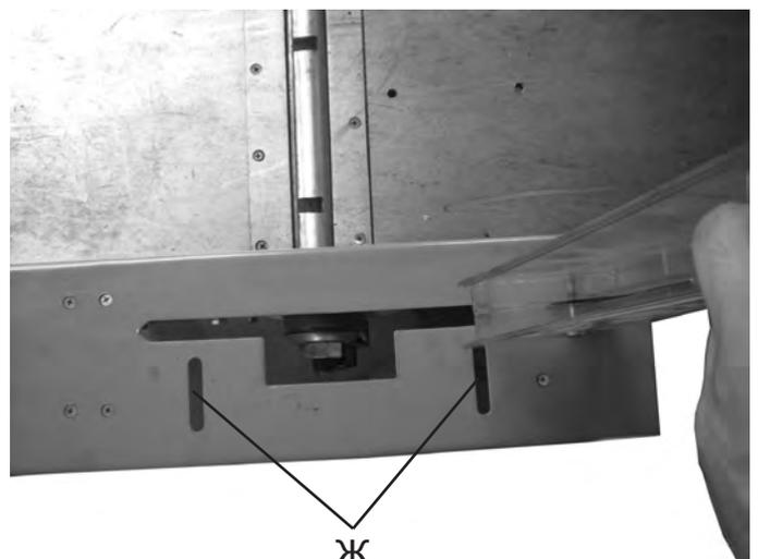
Параллельный упор крепится к пильному столу при помощи болтов и гаек.
