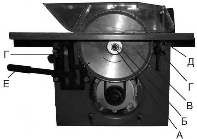
Снимите внешний фланец (Б). Установите пильный диск (В) на шпиндель. После чего установите на место внешний фланец (Б) и затяните гайку (А).
