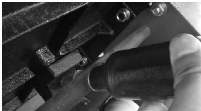
При вращении рукоятки настройки глубины строгания (13) по часовой стрелке подающий стол поднимается, таким образом, глубина строгания уменьшается. При вращении рукоятки против часовой стрелки подающий стол опускается, глубина строгания увеличивается. Настроив необходимую глубину строгания, вновь затяните винты (А).
