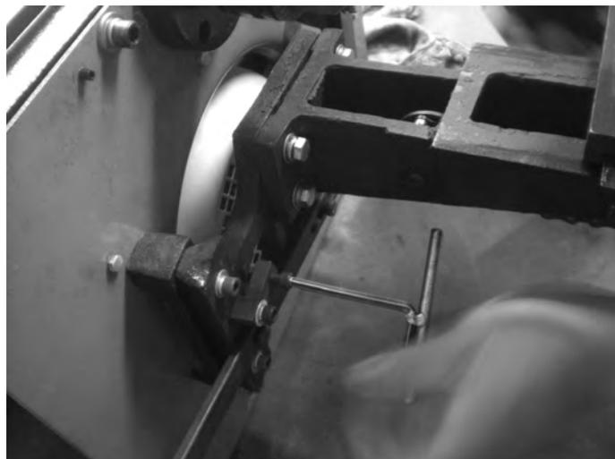
Передвиньте рычаг регулировки положения сверлильного стола (10), придав столу (15) необходимое положение.
