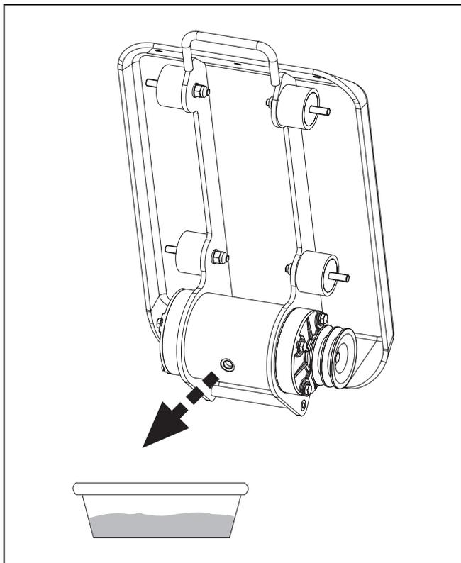
5. Снимите заглушку в верхней части вибратора. Переверните плиту, чтобы масло вытекло. Проверьте масло на предмет наличия металлической стружки для предотвращения проблем в будущем.
