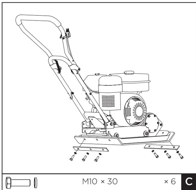
Закрепите коврик на виброплите, как показано на рисунке. Совместите отверстия в виброплите, коврик и прижимных пластинах. Закрепите коврик с помощью стопорных шайб 10 и болтов M10x30.
