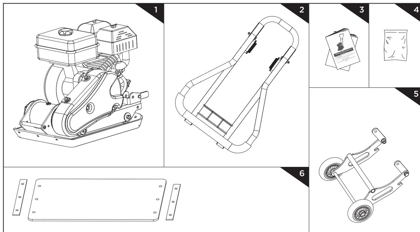
1. Рама трамбовочной плиты с двигателем и трансмиссией и баком для воды
