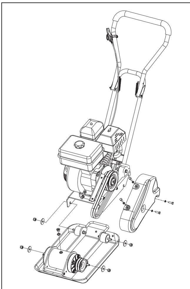
2. Снимите кожух ремней и ремни.
