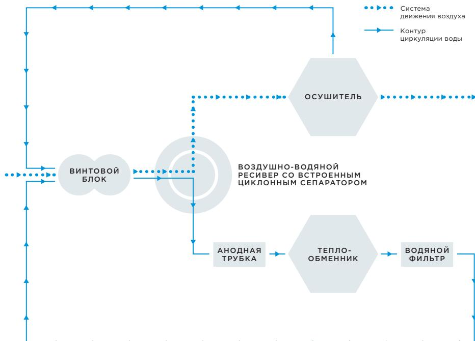
Замкнутая и автономная система со встроенным осушителем и системой подготовки воды. Контроль за уровнем и качеством воды происходит в автоматическом режиме.
