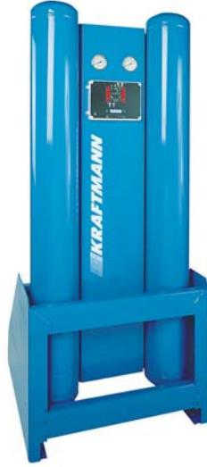
Оснащенные активированным оксидом алюминия, данные осушители в стандартном режиме обеспечивают точку росы  $-40^{\circ}\text{C}$ . При этом осушитель оснащен электронным блоком управления, позволяющим изменять продолжительность цикла осушки и достигать точки росы от  $+3$  до  $-70^{\circ}\text{C}$ . В качестве опции для данных осушителей доступен блок управления второго уровня.
