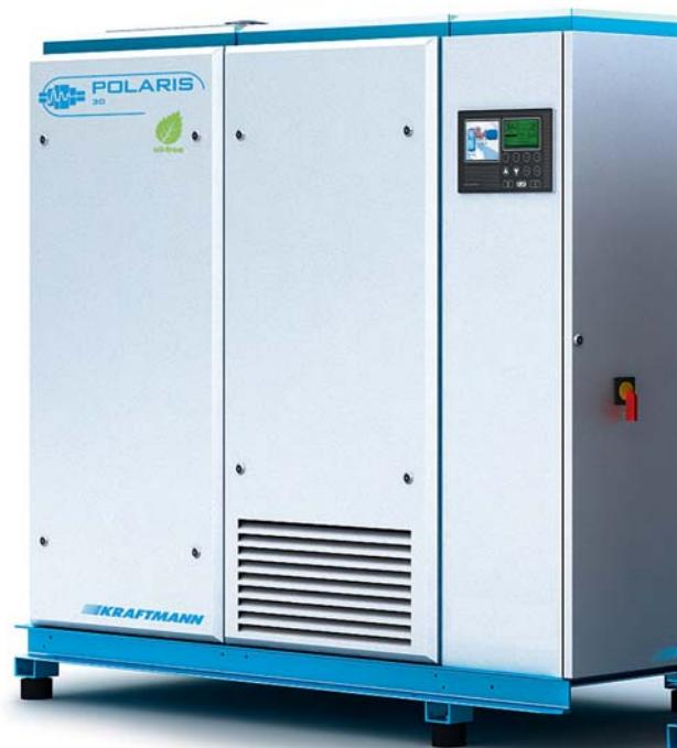
В данной серии попадание масла в воздух исключено на конструктивном уровне, так как вместо масла в качестве охлаждающей жидкости используется вода. Таким образом, безмасляные компрессоры POLARIS с водяным впрыском обеспечивают гарантию от попадания масла в сжатый воздух и полную экологическую безопасность производства, что подтверждено строжайшими стандартами зарубежных институтов.
