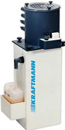
Предназначены для разделения конденсата на составляющие — масло и воду. Обладая высокой степенью эффективности, они позволяют сливать воду, очищенную от загрязнений, в канализацию, не загрязняя окружающую среду. OWS-р — масло адсорбируется в фильтре и утилизируется вместе с фильтром. OWS — отработанное масло собирается в маслосборнике и утилизируется.
