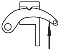
Рис. 1 – Положение переключателя при подъеме груза
